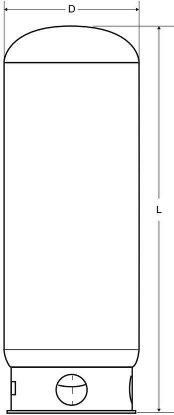
*Depósitos de diseño y fabricación específica para **HIDRÓGENO GAS** comprimido, destinados a estaciones de suministro de hidrógeno o uso industrial.*
