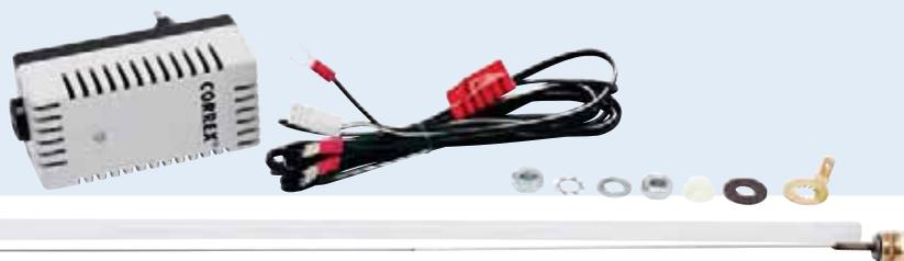
Protection cathodique permanente "lapesa correx-up": Équipement de protection cathodique permanente qui ne demande pas de maintenance. Ces anodes ne subissent pas d'usure et émettent le courant nécessaire automatiquement pour la protection cathodique du ballon, au travers d'un potentiostat individuel par anode, raccordé au courant électrique.
